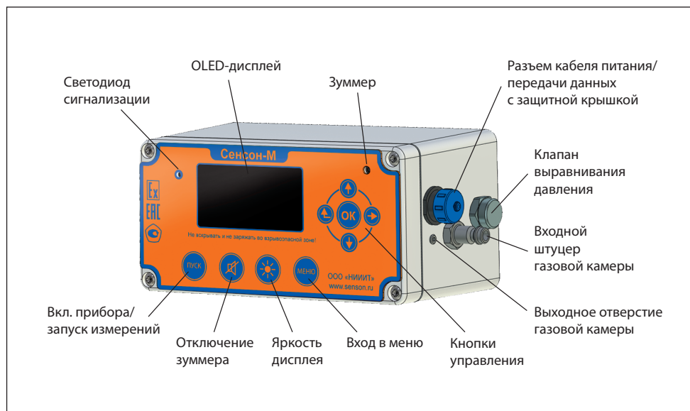
Рис.2. Газоанализатор "Сенсон-М". Органы управления
