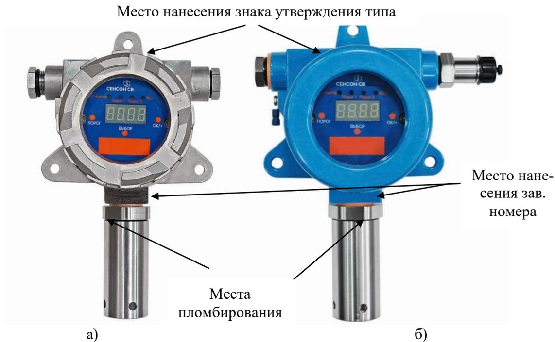
Рисунок 4 - Общий вид газоанализатора, модель «Сенсон-СВ»: а) исполнение 5031 в корпусе из нержавеющей стали; б) исполнение 5031 во взрывозащищенном корпусе из алюминиевого сплава
