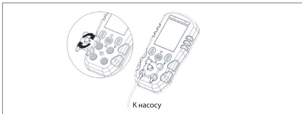
Рис. 5. Подключение насоса пробоотборного к газоанализатору посредством газовой насадки
