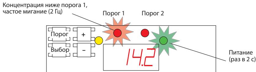
Рис.6. Особенности индикации в режиме  $O_2$
