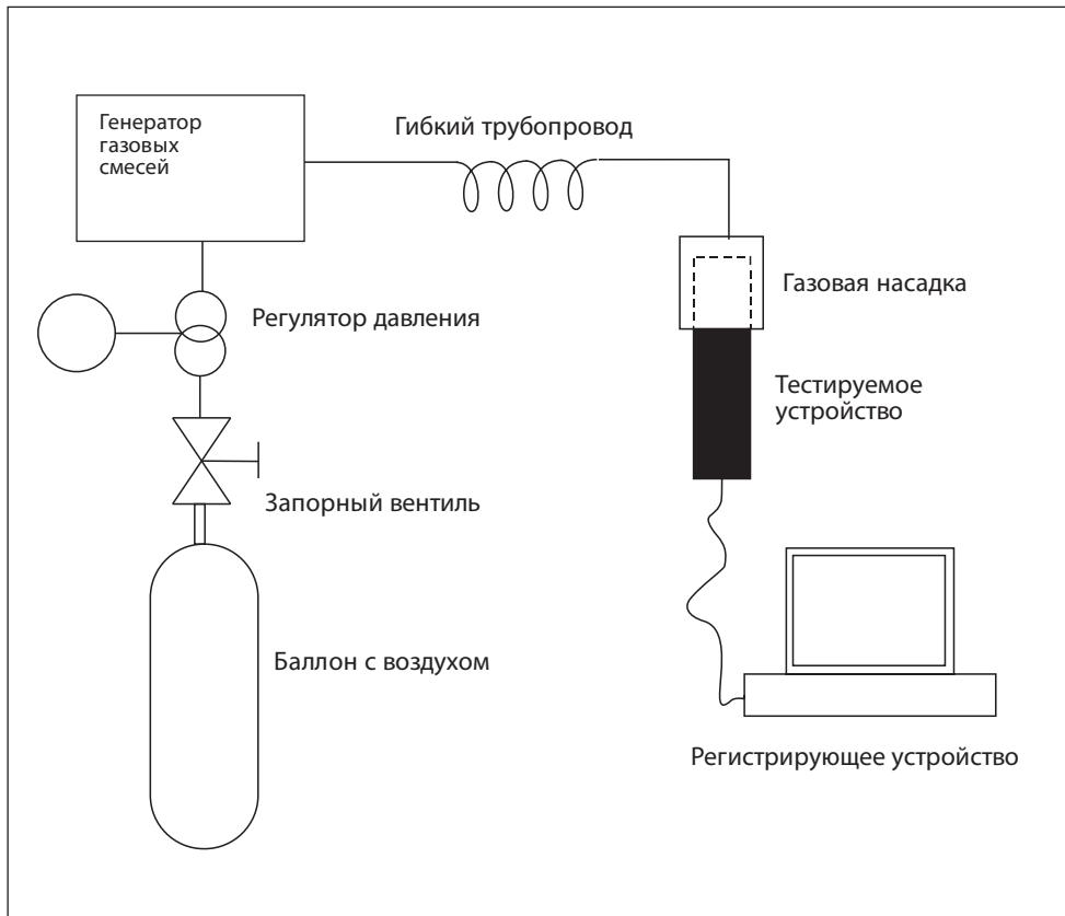
Рис.55. Стенд для работы с опасными газами
