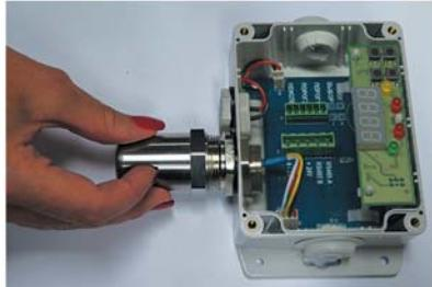
Рис.4. Подключение интеллектуального сенсорного модуля
