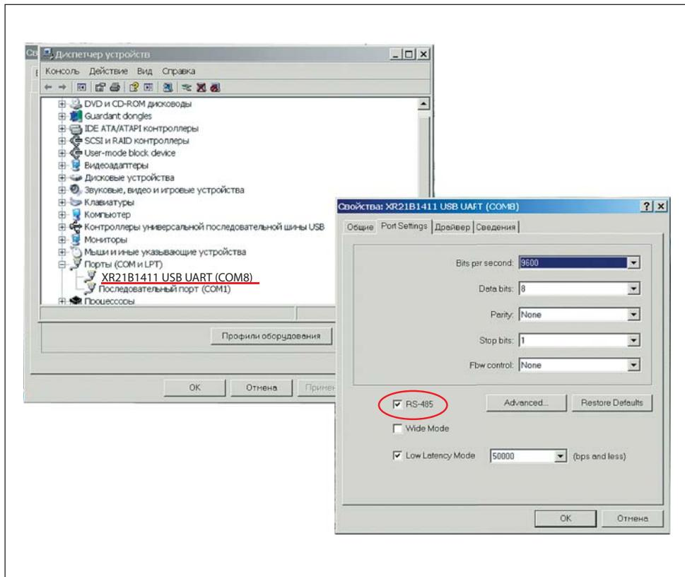
Рис.52. Определение номера COM-порта на вкладке Диспетчер устройств и установка режима RS-485
