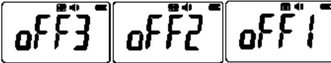
После этого экран погаснет. Отпустите кнопку, и прибор выключится. Затем сразу отпустите кнопку. **Долгое удержание кнопки после выключения прибора может привести к переходу прибора в режим калибровки.**
