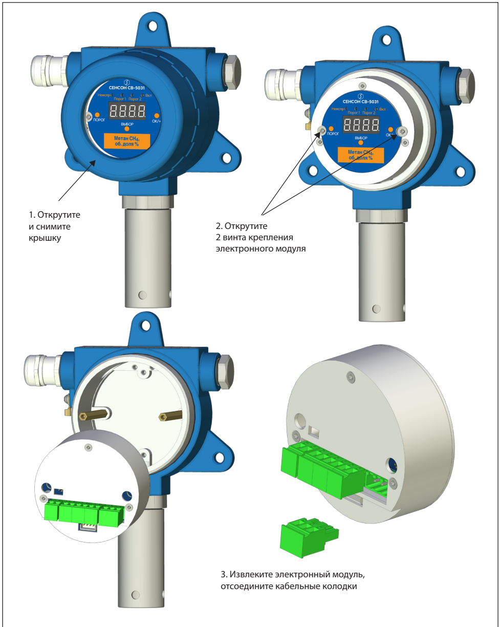
Рис. 10. Порядок разборки МКТИ-2
