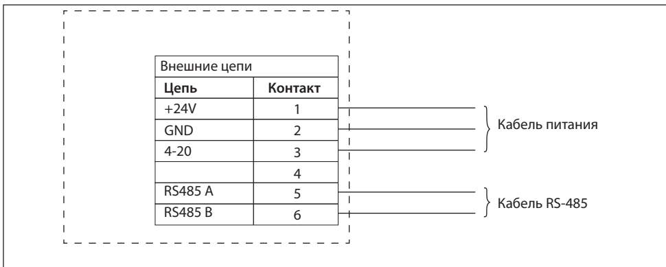
Рис.7. Схема подключения ГС "Сенсон-СД" исполнения 7032 и 7033
