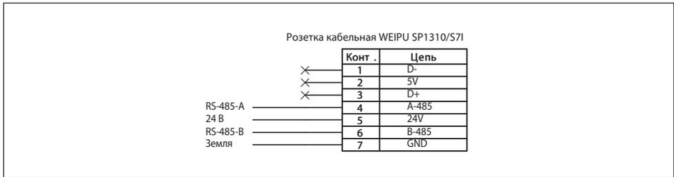
Рис.3. Схема распыйки коннектора при подключении к сети электропитания 24 В и сети передачи данных на основе RS-485.
