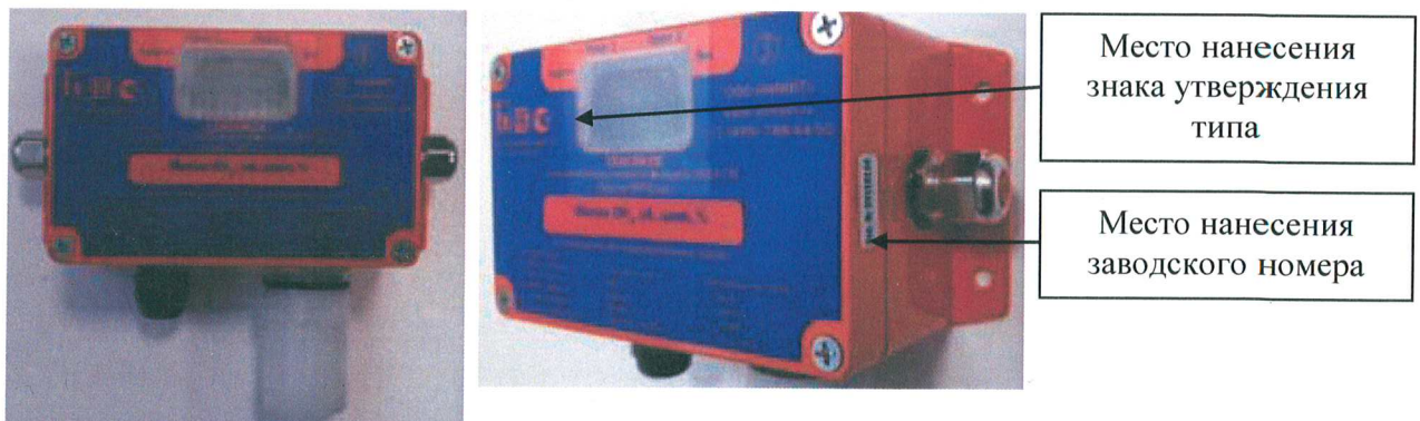
Рисунок 5 - Общий вид исполнения МКТИ-1м, с указанием места нанесения знака утверждения типа, места нанесения заводского номера
