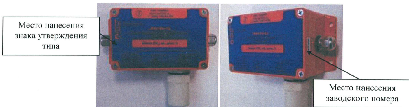
Рисунок 2 - Общий вид исполнения MKT-2м, с указанием места нанесения знака утверждения типа, места нанесения заводского номера
