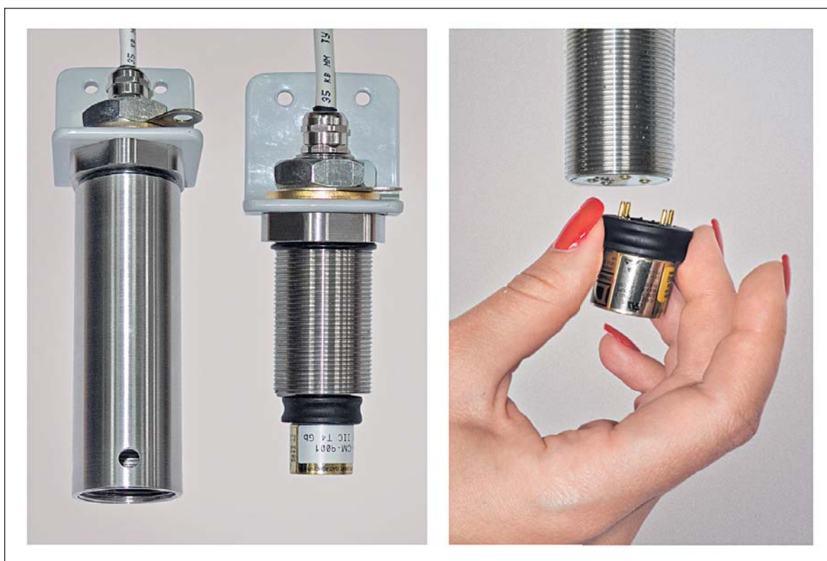
Рис.3. Извлечение ИСМ из корпуса "Сенсон-СД-7031-СМ"
